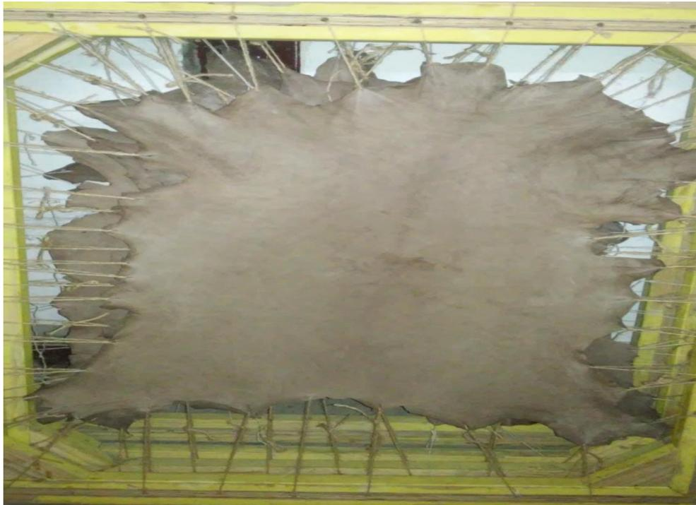
**Figura 14: Secado y estirado de cuero wet-white en bastidores**
