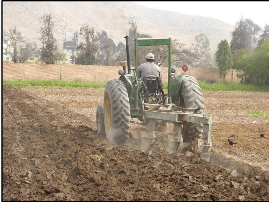
**Figura N° 6. Incorporación mecanizada de los residuos de brócoli y del estiércol a las parcelas correspondientes**
