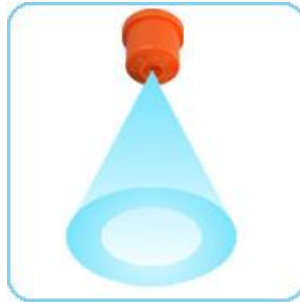
Figura 3: Patrón de cono hueco.
