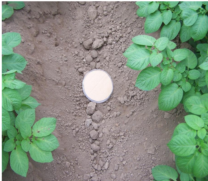
Figura 13: Placa Petri con cartón colocado en campo para la recolección de Cobre.
