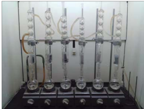
Figura 25: Equipo Soxhlet, utilizado para extracción de las materias solubles en diclorometano.
