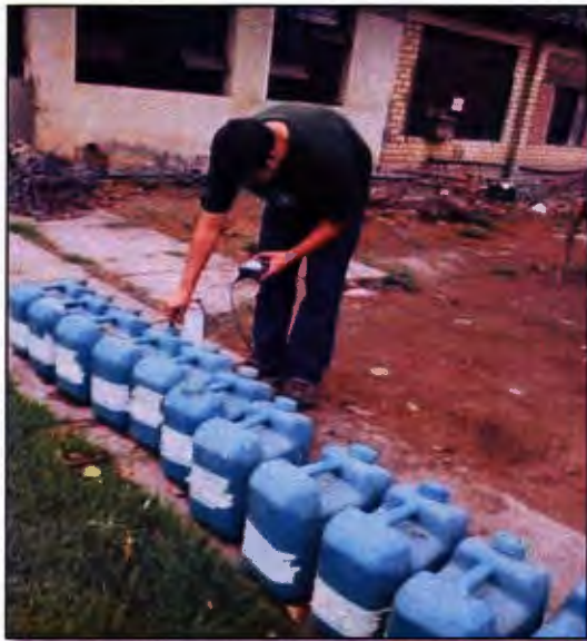
Figura N° 02: Control del nivel de salinidad en los tratamientos
